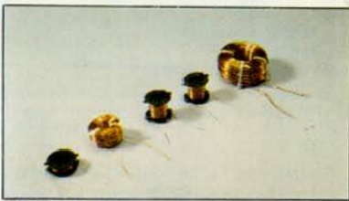
Nella foto è indicata una possibile realizzazione pratica delle bobine (da destra a sinistra) L1, L3, L4, L2, L5. Le dimensioni A e B del rocchetto (a destra) sono indicate nell'elenco componenti.
