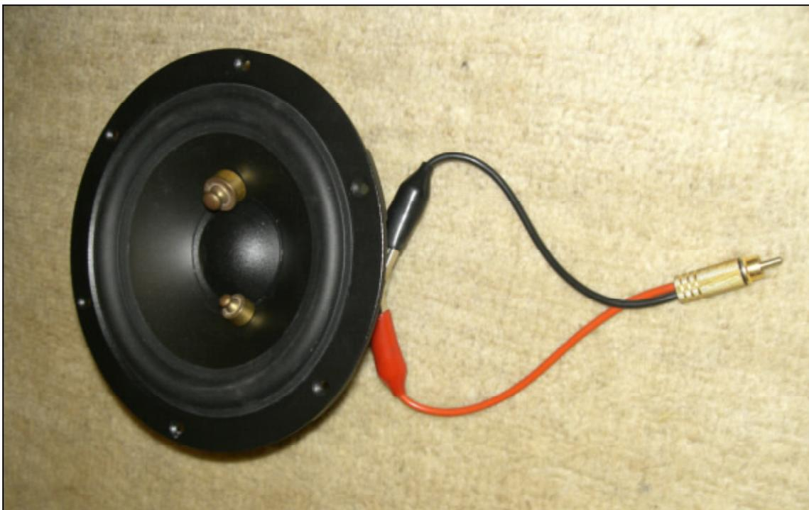
*Uno dei due HW-172 prima delle misure dei suoi parametri T&S.*
