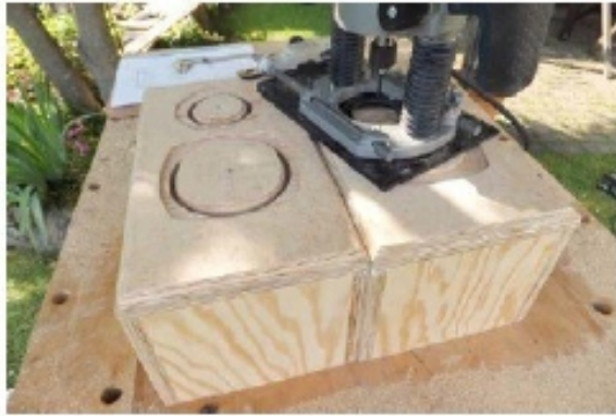
Fig 4. Si realizzano i fori per i trasduttori.
