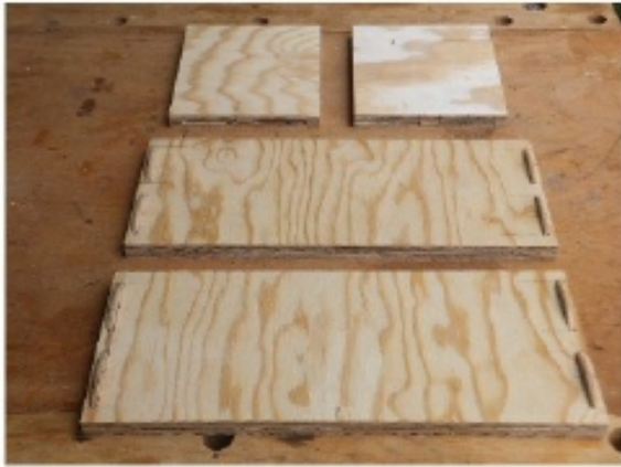
Fig1. Assemblaggio delle pareti laterali del mobile.
