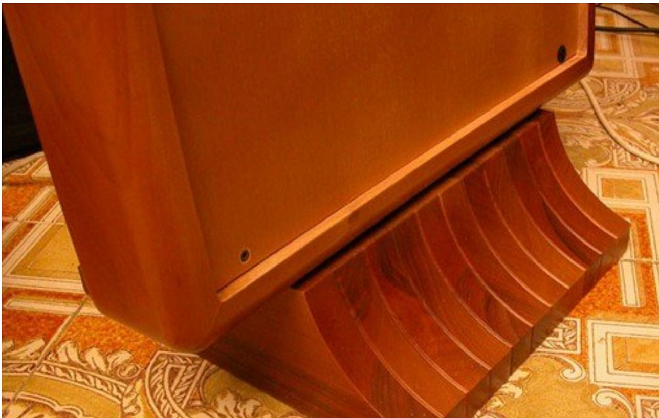
Una volta rimossi i pannelli portatela fissati con Velcro si possono vedere gli altoparlanti impiegati, che sono due woofer da 8", e un midrange da 5" a cono (montati in modo da poter emettere anche posteriormente) ed un tweeter a cupola morbida da 1". Tutti i trasduttori sono prodotti in Italia dalla Ciare di Senigallia per Concentus.
