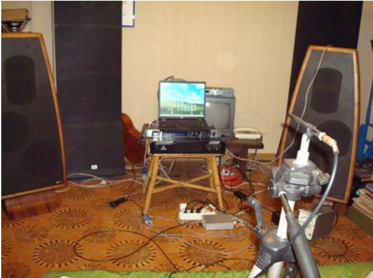
**Per l'unica misura:** abbiamo posizionato le casse ad 1 m dalla parete. **Il microfono** è stato posto a 2 metri di distanza dai centri dei pannelli portatela di ciascuna delle due casse, centri che distavano fra loro esattamente 2 metri, a 110 cm dal piano del pavimento.
