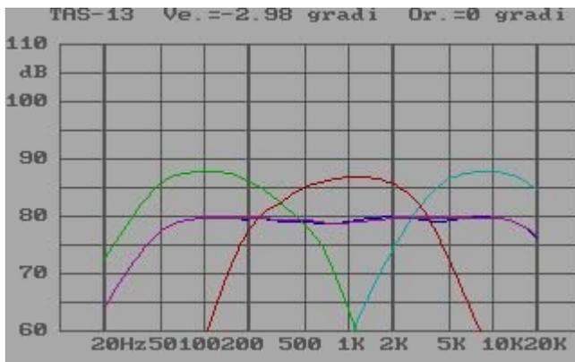
E il diagramma polare alla nuova frequenza d'incrocio ridotta da 3500 a 3000 Hz è questo:
